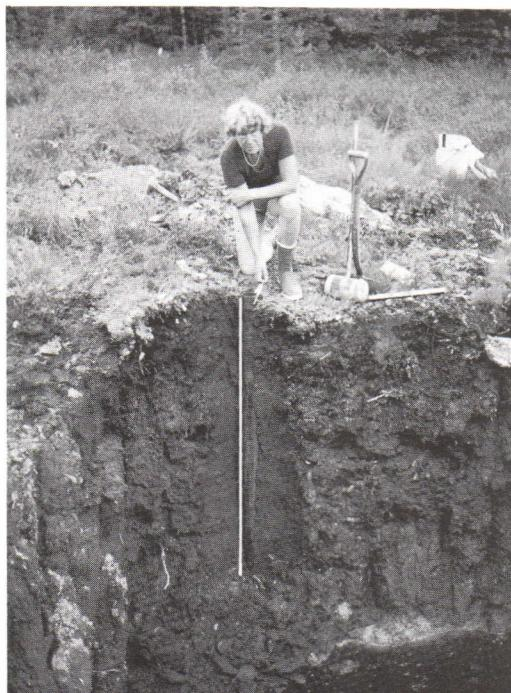
Fig. 1. Torvsøyler som skal avsløre granskogens historie tas opp i sammenhengende lengde i myrene ved hjelp av 10 cm vide plast anleggssrør som er kuttet i lengder på 2 til 3 m og skarpt kvesset langs nedre rand for lett å kunne skjære seg ned gjennom torven.
