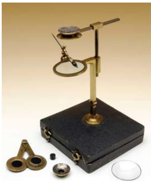
Figur 5. Gunnerus' Cuff-mikroskop slik det i dag finnes ved Vitenskapsmuseet, manglende det nedre speilet. Foto: Per Fredriksen, Vitenskapsmuseet.
